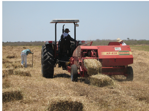
Foto 2. Máquina para confeccionar fardos de feno. Distrito de irrigação de Ponto Novo. Município de Ponto Novo. Bahia. Brasil. 2008. Fonte: SILVA, 2008, p. 375.
